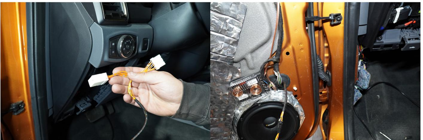
3. Verbinden Sie nun die Kabel der Spiegelverstellung mit dem Kabelbaum des Komfortmoduls
