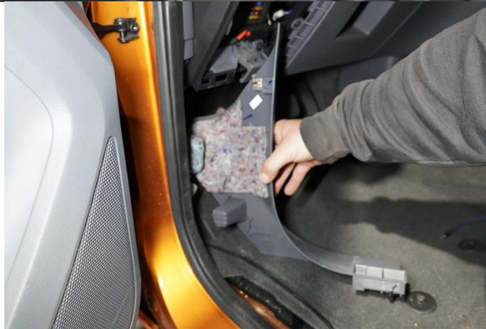
2. Entfernen Sie die serienmäßigen Stecker von der Spiegelverstellung und stecken den Adapter dazwischen. Verlegen Sie nun das Kabel am Sicherungskasten lang in den Fahrerfußraum und führen es durch die Gummimanschette in Richtung Tür.
